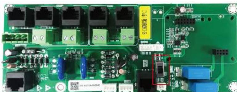
Рисунок 4.2 Переключатель между PLC и RS485 соединением.
