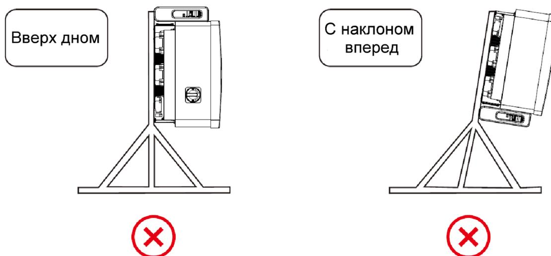
Рисунок 3.10 Неправильный угол наклона при монтаже
