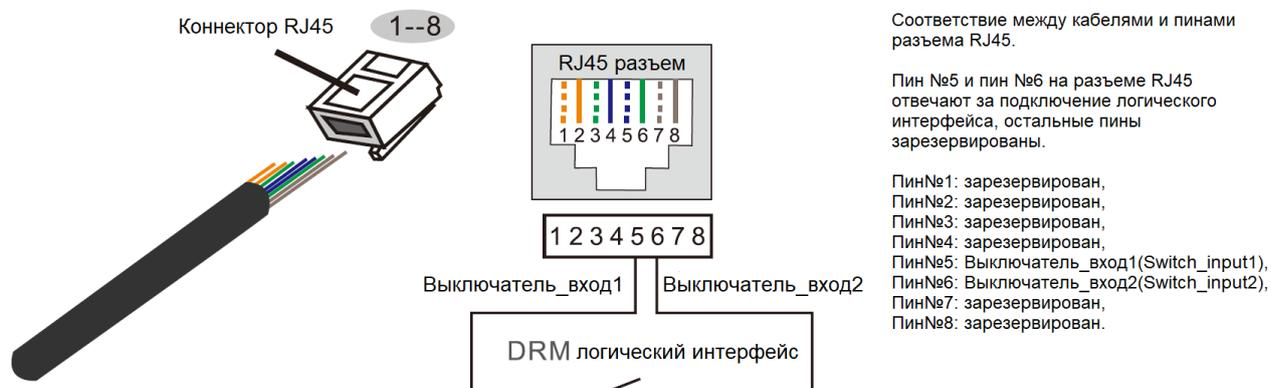
Рисунок 4.3 Удаление изоляционного слоя и соединение с коннектором RJ45.
